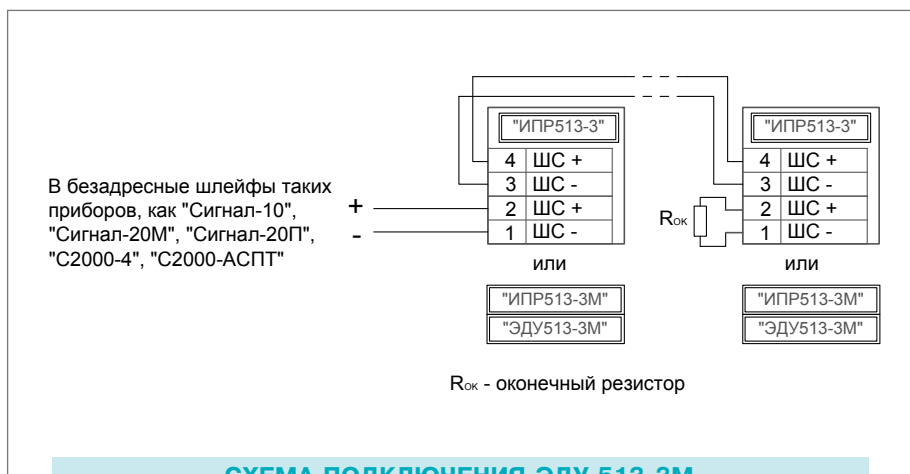
СХЕМА ПОДКЛЮЧЕНИЯ ЭДУ 513-3М
