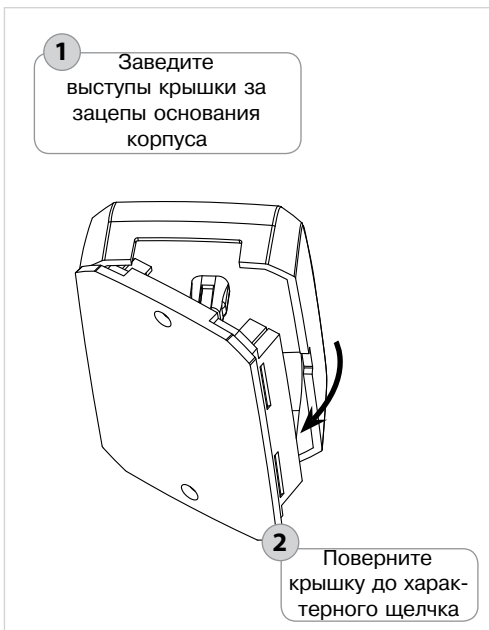
Рисунок 26. Установка крышки прибора
