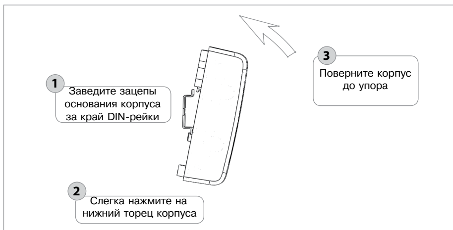
Рисунок 23. Порядок установки прибора на DIN-рейку
