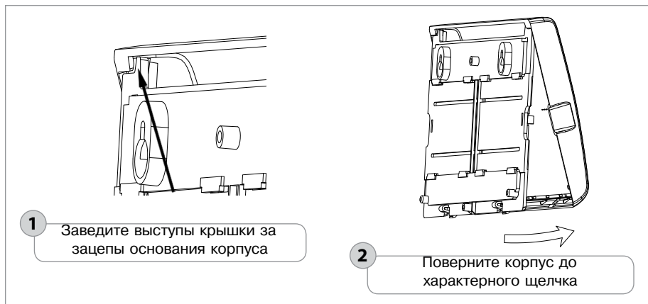
Рисунок 18. Установка крышки прибора «Сигнал-20М»
