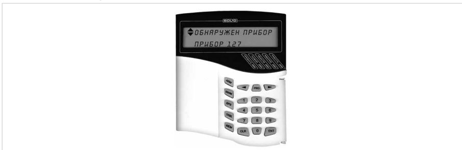
Рисунок 1. Индикатор пульта «С2000М» с соответствующим сообщением
