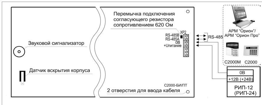
Рисунок 1. Схема внешних соединений блока «С2000-БИ SMD»
