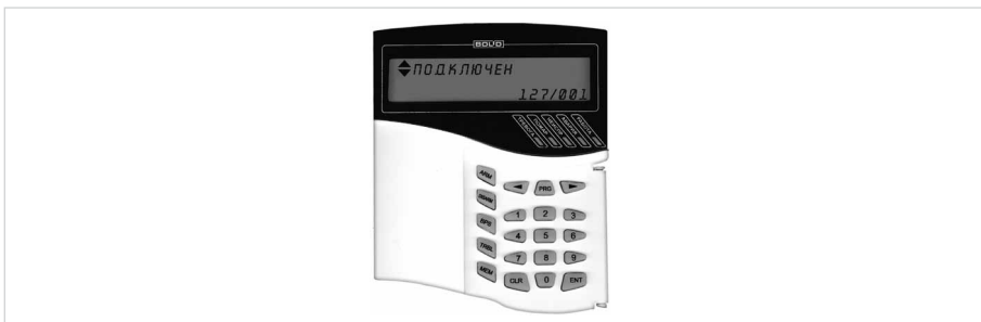
Рисунок 1. Индикатор пульта «С2000М» с соответствующим сообщением
