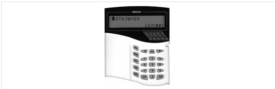
Рисунок 2. Индикатор пульта «С2000М» с соответствующим сообщением
